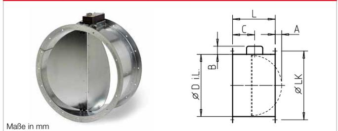
■ **Motorbetätigte Rohrverschlussklappe**<sup>1)</sup> wie RVS, jedoch horizontal und vertikal in jede Richtung einbaubar und mit angebaute Federrückstell-Motor (außerhalb Luftstrom). Elektr. Ansteuerung parallel mit Ventilator; Kabellänge 0,9 m, stromlos geschlossen.
