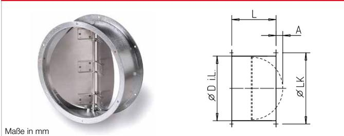
■ **Selbsttätige Rohrverschlussklappe mit Federrückstellung**<sup>1)</sup> Horizontal in jede Richtung, vertikal mit Durchströmung von unten nach oben einbaubar. Klappenöffnung in Strömungsrichtung; automatische Funktion durch Ventilatorbetrieb.
