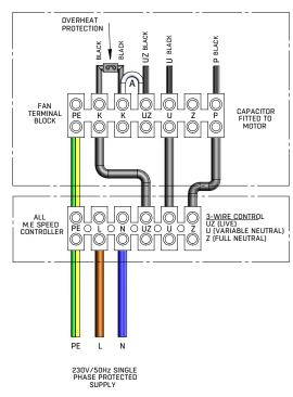
FAN CONNECTED TO SPEED CONTROLLER (VARIABLE SPEED)
