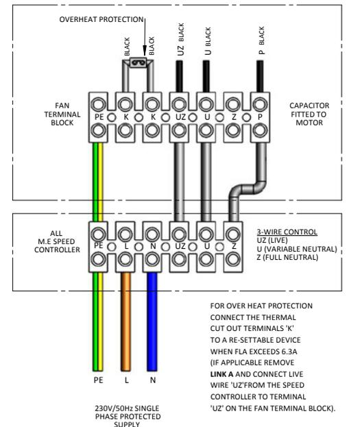
FAN CONNECTED TO SPEED CONTROLLER (VARIABLE SPEED)
